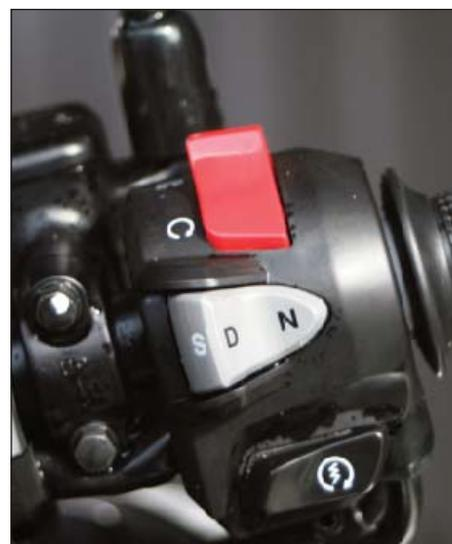
Unter der Sitzbank liegt der Tankneinfüllstutzen und ein kleines Staufach (rechts), das kaum einen Helm fasst. Das funktionsreiche Tastenarrangement am linken und rechten Lenkerende für das DCT verlangt einiges an Koordination und Eingewöhnungszeit und ist mit dicken Handschuhen nur schwer zu bedienen.
