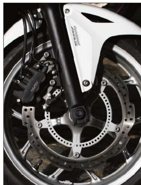
Stopp-Power: Beim Betätigen der Hinterbremse wird ein Teil der Bremskraft auf den mittleren Kolben der vorderen Dreikolbenzange verteilt.
