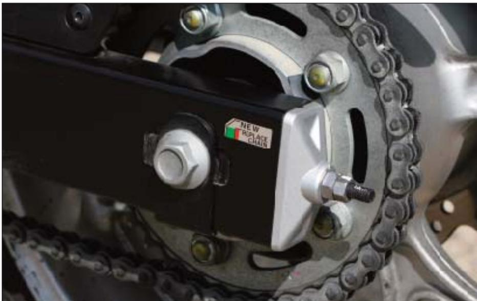
Ungewohnte Arbeiten: Beim Integra gehört Kettenpflege in Form von Schmierens und Spannen zum Programm, der simple Kettenspannmechanismus ist allerdings keine Augenweide. Praktisch und gut erreichbar präsentiert sich der Ölpeilstab neben dem rechten Trittbrett, der Füllstand wird aufgelegt gemessen.
