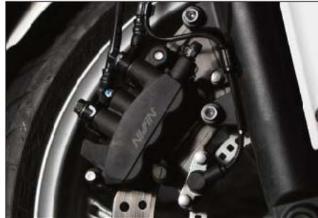
Klar gegliedert und bis auf die oben laufende Drehzahlleiste gut ablesbar präsentiert sich das aufgeräumte LCD-Instrument, das über eine hilfreiche Ganganzeige verfügt. Hilfreiche Stopporgane sind die Handbremse (oben links) im rechten Bug und die Dreikolbenzange der Einzelscheibe im Vorderrad.
