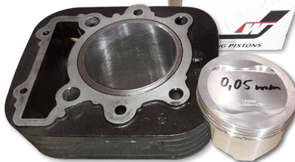
De Wiseco-zuiger past met 0,05 mm speling in de nieuwe cilinder.
