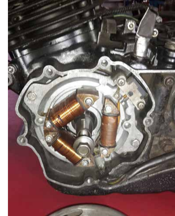
De 6-volts dynamo werd vervangen door een 12 volt exemplaar van de XT350.
