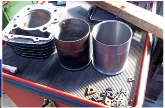
Die Grauguss-Zylinderbuchse kann ersetzt werden
