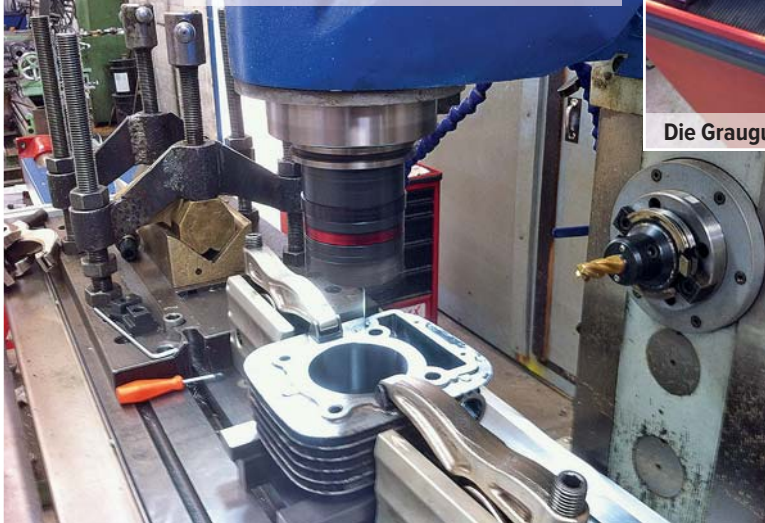
Nach dem Bohren wird der Zylinder gehont
