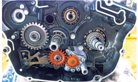
Bei der XT treiben Kunststoffräder die Ölpumpe an
