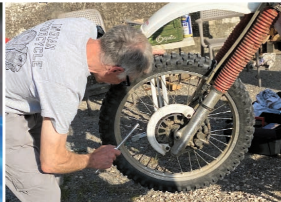
Lieber am Abend mit feinem Ohr die Speichen abdengeln als anderntags ein Radbruch.
